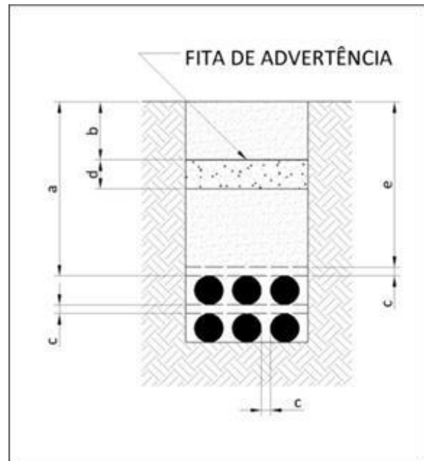
Figura 6 – Quadro de instrução de instalação de linha de dutos em locais de tráfego pesado / intenso
